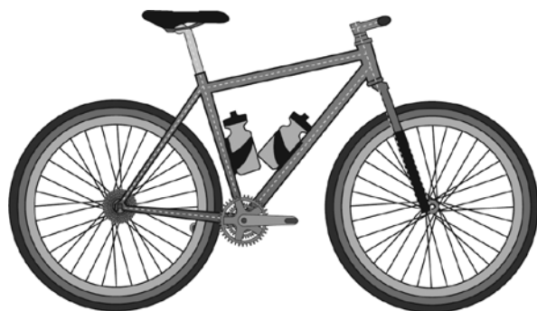
Рис. 6.2. Более крепкий горный велосипед с прямым рулем, передней подвеской и толстыми шинами
