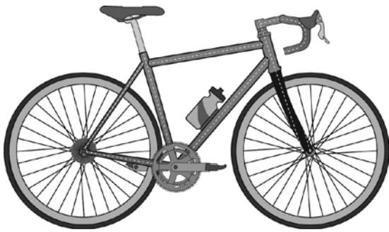
Рис. 6.1. Легкий дорожный велосипед с изогнутым рулем и тонкими шинами
